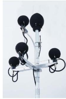
Microphone métrologique de mesure et système d'antenne acoustique
